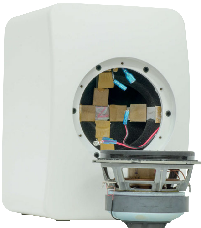
Il coassiale una volta rimosso mostra i rinforzi interni. Notare il materiale cedevole che isola i rinforzi dalla parete frontale e dal complesso magnetico del trasduttore.
