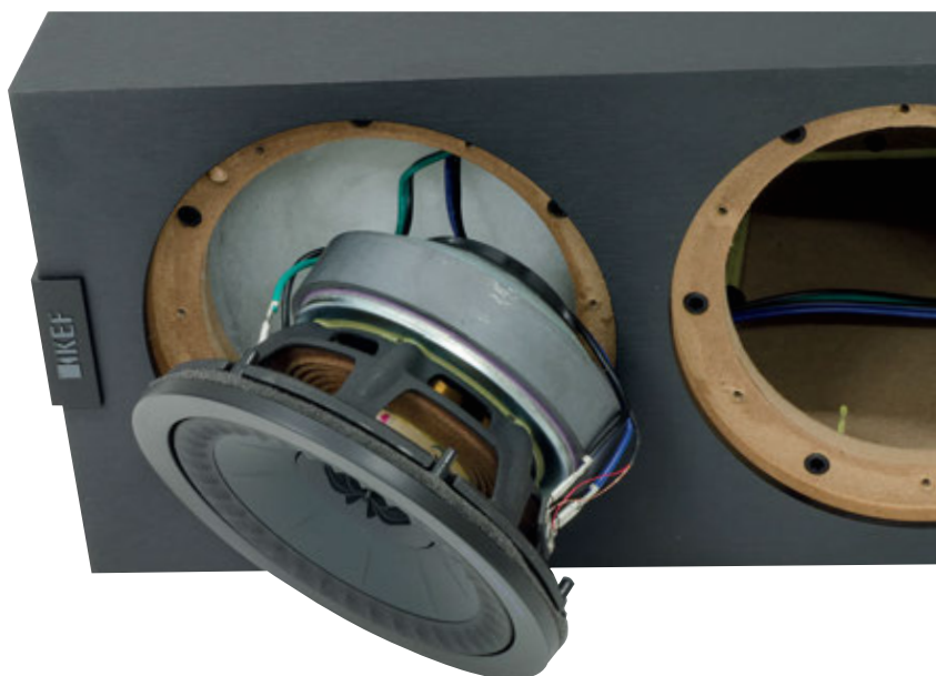
Il coassiale lavora in un volume chiuso riempito di materiale assorbente. Il disegno della bobina mobile e del complesso magnetico porta ad una linearità molto elevata, tanto da poter evitare il filtro passa-alto.
