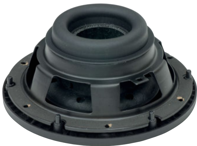
L'originale driver passivo disegnato per questo diffusore. Notare il secondo anello di sospensione, abbastanza rigido, e il cilindro interno che collega meccanicamente le due sospensioni.
