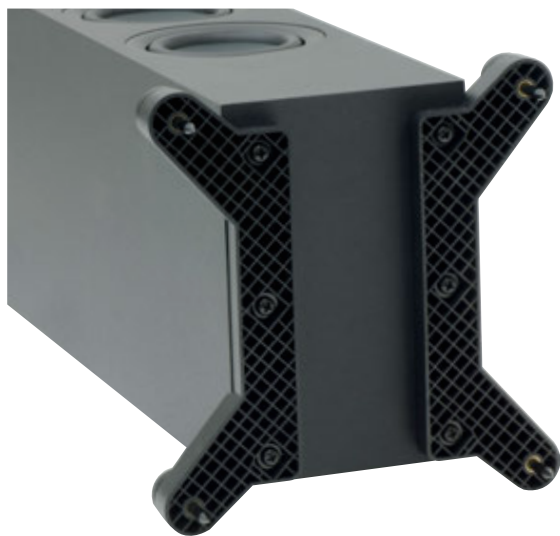
La base a terra alloggia le quattro punte e solleva di qualche centimetro la quota del tweeter.
