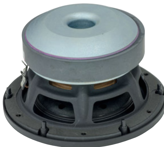
Il woofer è realizzato con un cestello stampato ed un disegno interno che gli consente escursioni lineari superiori alla media dei driver di 110 millimetri di diametro. Notare l'ampio foro di decompressione posteriore.
