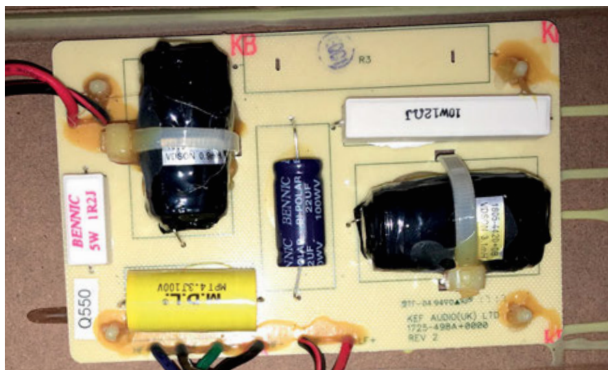
Il filtro crossover è letteralmente incollato alla base del diffusore. Notare i sei componenti utilizzati, in netto contrasto con le realizzazioni KEF storiche.
