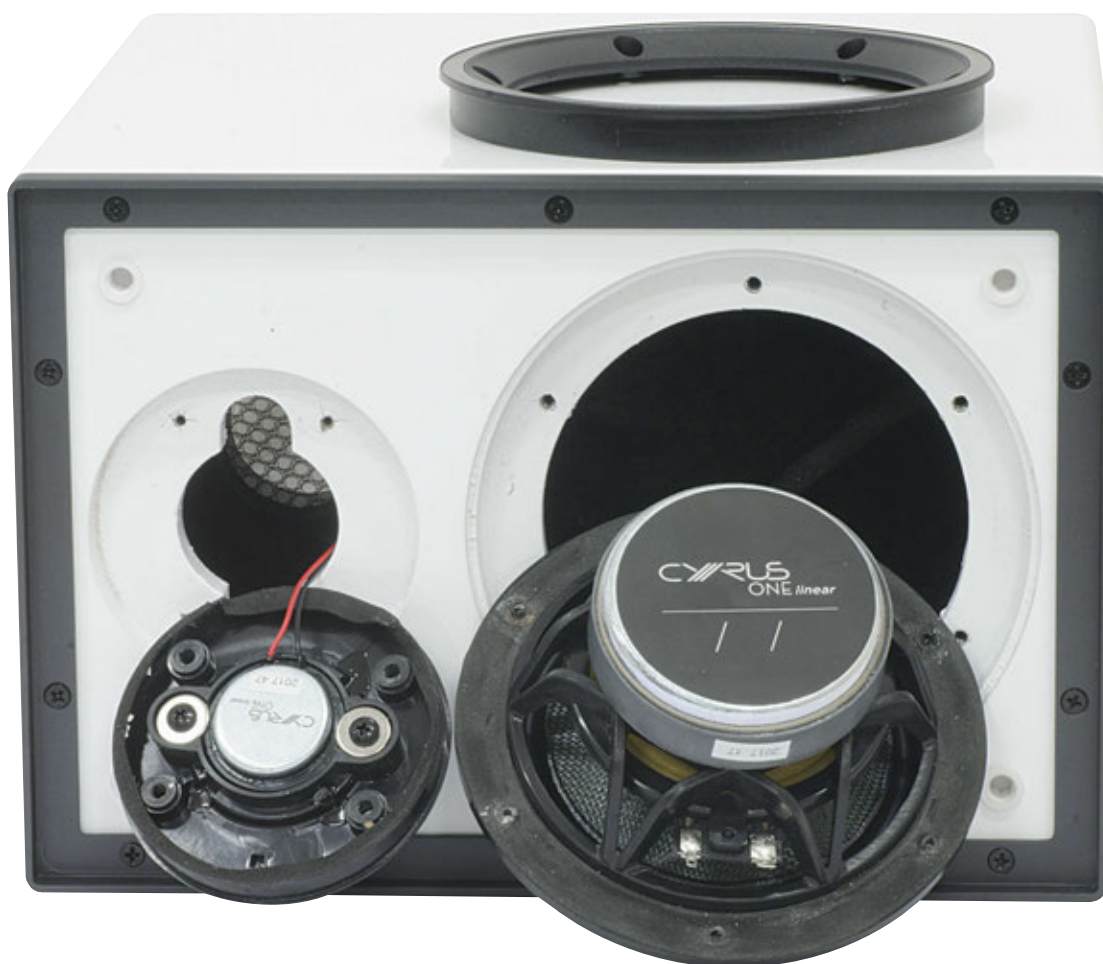
Il midwoofer utilizza una membrana in Kevlar sagomata con nervature di rinforzo. La bobina è in alluminio rivestito in rame, sfruttando la leggerezza del primo e la conducibilità del secondo. Il tweeter a cupola morbida è da 25 mm.
