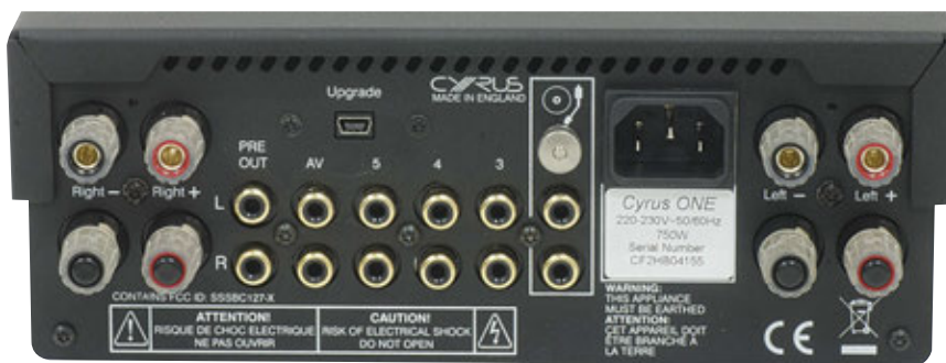
Sul retro dell'apparecchio molto spazio è occupato dai morsetti di uscita, sdoppiati per il bi-wiring. La porta USB denominata "upgrade" è riservata ad operazioni di assistenza e aggiornamento firmware.
