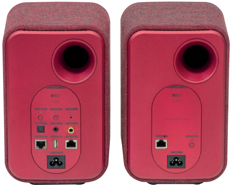
Le due unità sono esteticamente identiche davanti ma sul lato posteriore il diffusore che funge da master è dotato degli ingressi ottico Toslink, una presa di alimentazione USB e l'uscita RCA per il subwoofer. Entrambi presentano il foro del condotto di accordo reflex, la cui apertura è svasata esternamente e poi si snoda all'interno, la connessione per l'alimentazione e la presa RJ45 per la comunicazione via cavo tra i due canali.
