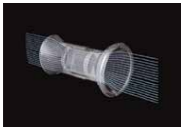
Dopo - la turbolenza è stata notevolmente ridotta nelle porte progettate con CFD per gli altoparlanti da scaffale
