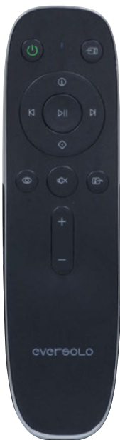
Il telecomando è ben fatto, con un guscio in acciaio cromato e batteria integrata ricaricabile attraverso la presa USB-C.
